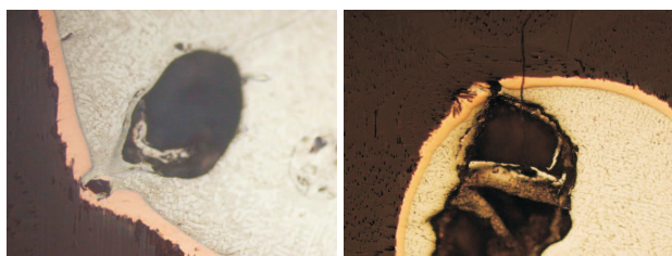
從圖5.看，在孔壁的破洞處吹出氣體，推開尚未固化的熔錫，形成“吹孔”。
