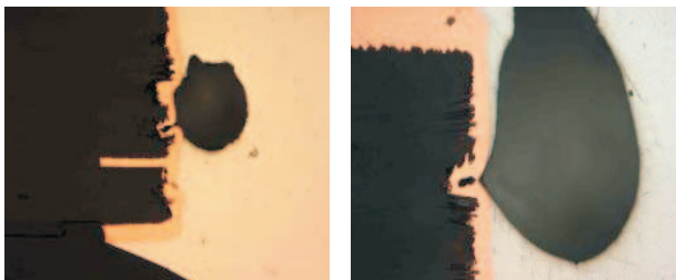
圖2. 孔壁粗糙導致的吹孔
